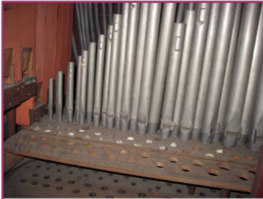
Dépose de la tuyauterie du Récit
