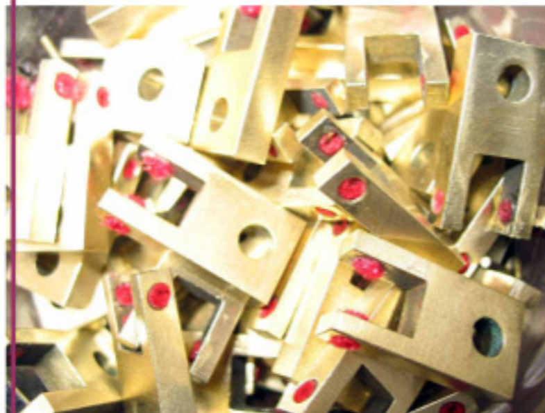
Restauration des crapaudines de balancier, remplacement des garnitures de casimir
